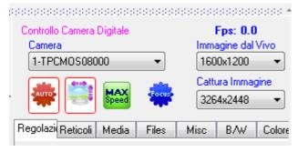
Per visualizzare il pannello di controllo della camera, dal menù principale Video selezionare **Setup Camera** oppure selezionare la linguetta "Video" presente sul lato destro del programma.
