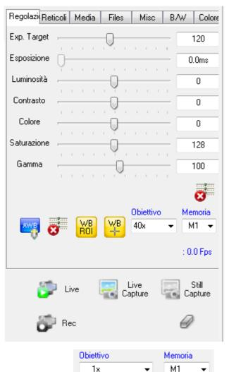
La camera dispone dei seguenti controlli: Guadagno (Exp. Target), Esposizione, Luminosità, Contrasto, Colore, Saturazione e Gamma.
